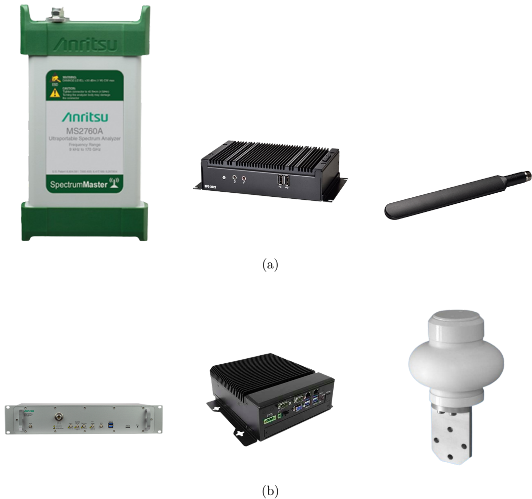
Figura 3.2: In (a) i componenti del nodo ultraportable: da sinistra, Analizzatore ultraportable Anritsu MS2760A, PC Embedded BPC-3022, Antenna Anritsu 2000-1751-r; in (b) i componenti del nodo fisso: da sinistra, Analizzatore rack Anritsu MS27201A, PC Embedded AVS520, Antenna Steatite Omni QMS-00017
